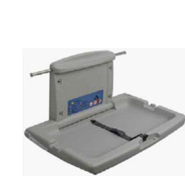
PAÑALERA Poliuretano / Resistencia de 30 k abierto. Protección antimicrobiana. Estructura neumática, bisagra oculta para proporcionar una controlada, suave apertura.
