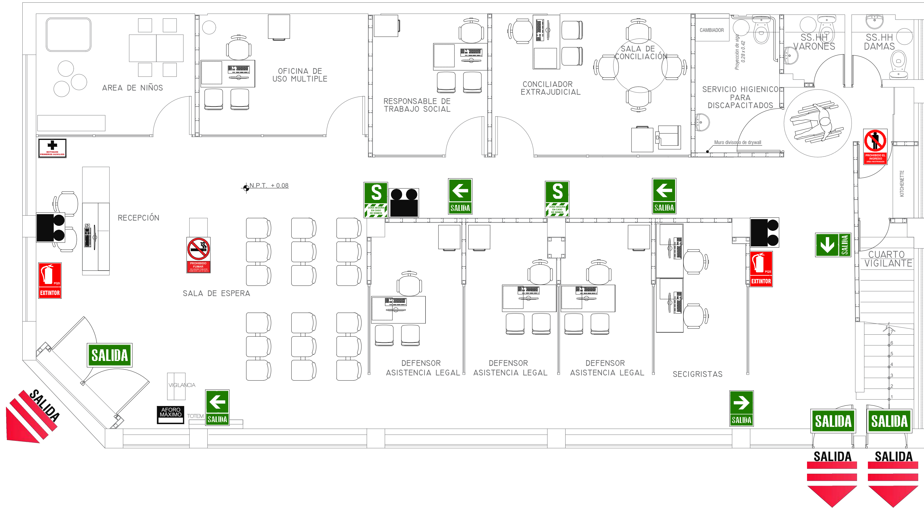
1 PLANO DE SEÑALIZACION-PRIMER PISO ESCALA: 1/50
