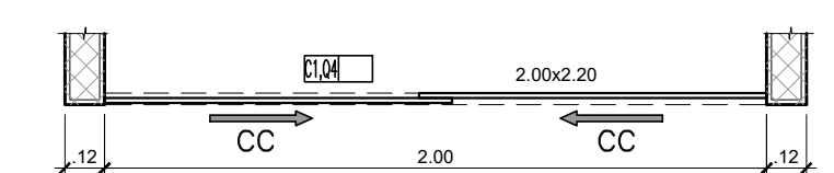
PLANTA Mampara M-4 (CUARTO DE COMUNICACIONES) ESC:1/25
