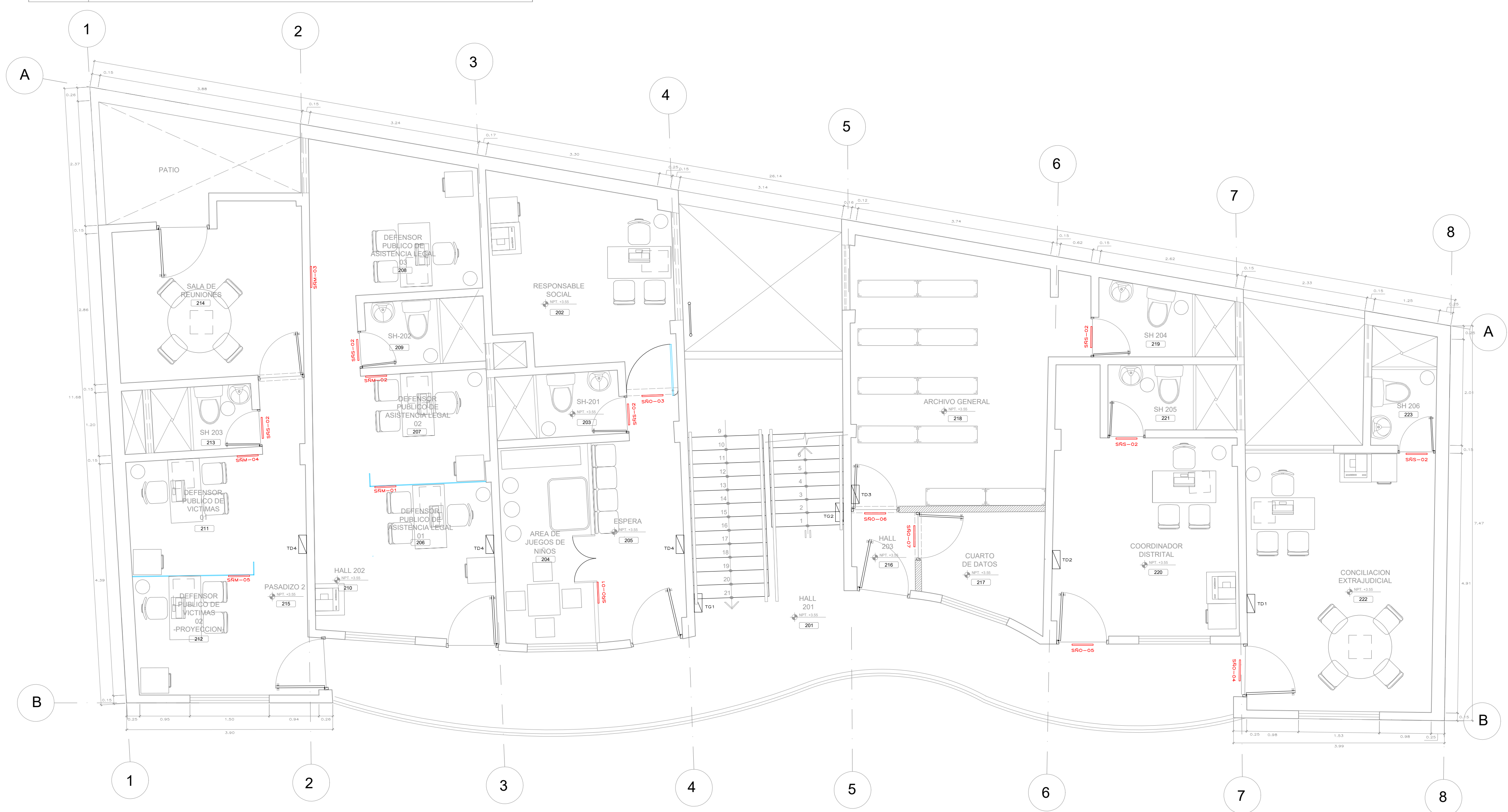
DISTRIBUCION SEGUNDO PISO - PROPUESTA ESCALA 1/50
