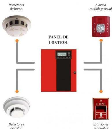
Sistema de Detección y Alarma Contra Incendios
