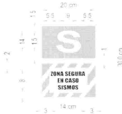
Señal de indicación de zona segura adosado en columna
